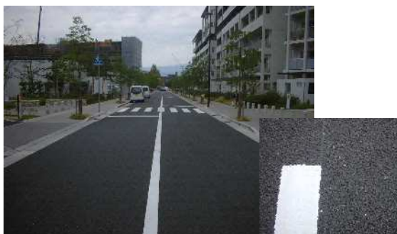
透水性舗装・雨水浸透柵の事例(浜甲子園団地)
