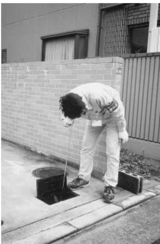
漏水の音聴調査作業
