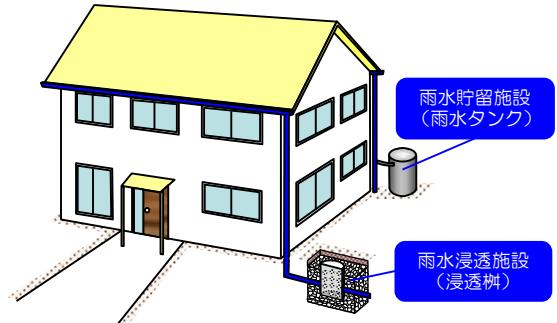
雨水貯留施設（雨水タンク）の設置例
