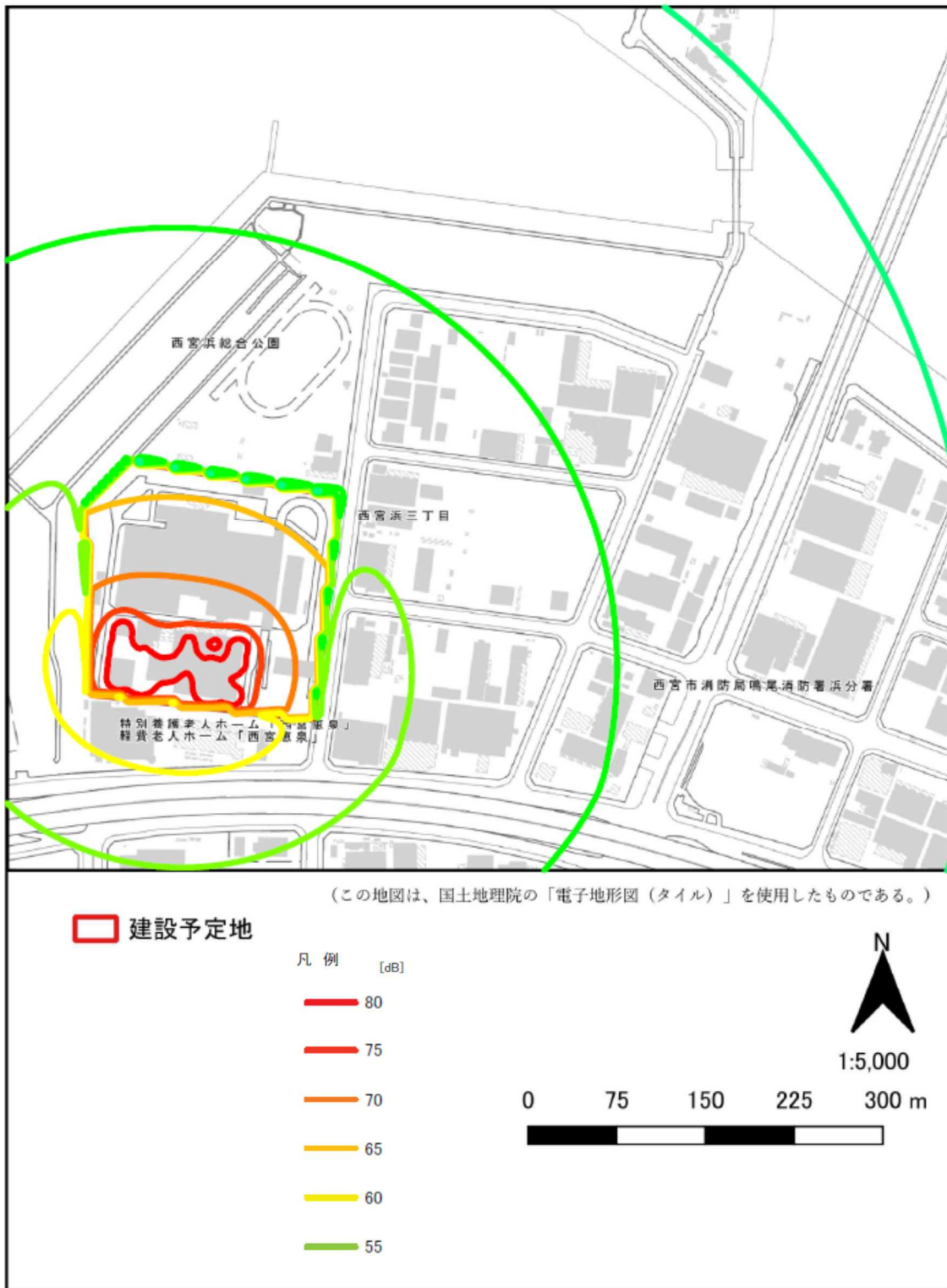
図4-2-16 建設機械の稼働に伴う騒音の予測結果 (昼間 寄与騒音: L_{A5} ) (防音パネル: 有、1期: 破碎選別施設解体)
