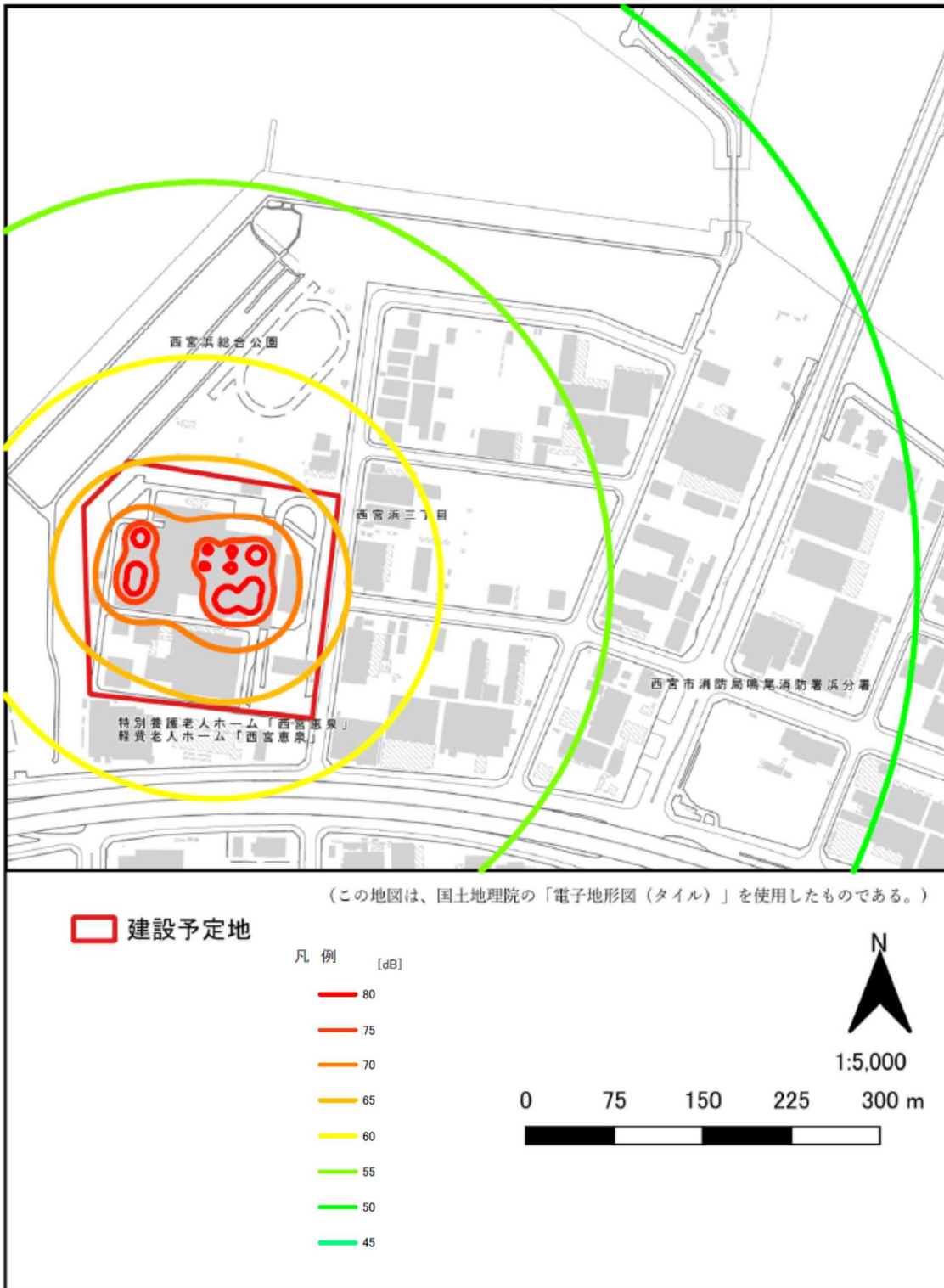
図4-2-19 建設機械の稼働に伴う騒音の予測結果（昼間 寄与騒音： L_{A5} ） （防音パネル：無、3期：既設焼却施設解体）
