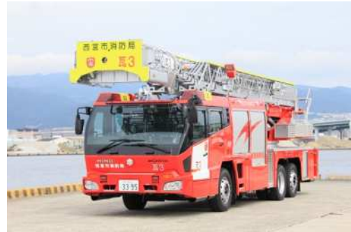
はしご付消防ポンプ自動車(はしご車) 【瓦木消防署】
