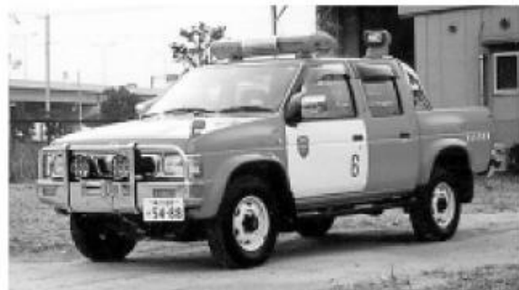
各署に配置された小型動力ポンプ付積載車
