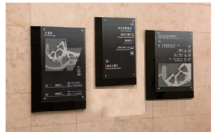
設置高さが揃っていないと情報が読み取りにくい
