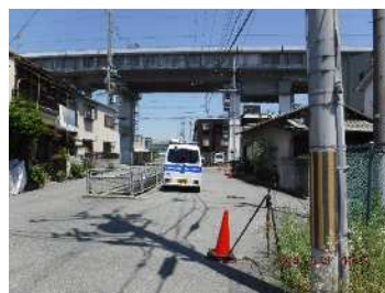
図4-2 新幹線騒音の測定
