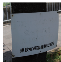
劣化によって情報が消えている
