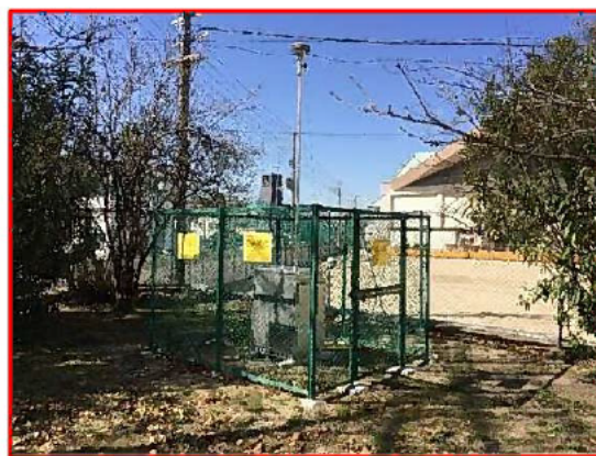
【ネットフェンス・PM2.5自動測定器】
