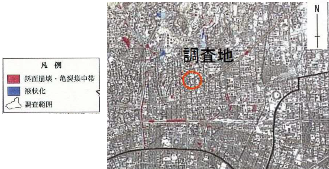
図 5.3.6 調査地付近の阪神大震災被害状況分布図(斜面崩壊、液状化)
